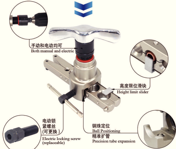
手动电动两用偏心扩管器 (45°) MANUAL&ELECTRIC ECCENTRIC FLARING TOOL(45°)
